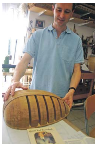
Einzelne Holzstreifen, auch Späne genannt, werden über einer Form mit Warmleim verleimt für den späteren Lautenkorpus oder „Muschel“
